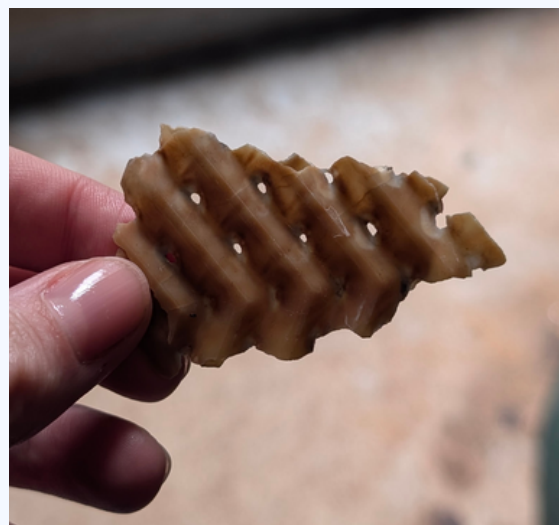
Calcaire retiré des plaques de l'échangeur sur une chaufferie collective
